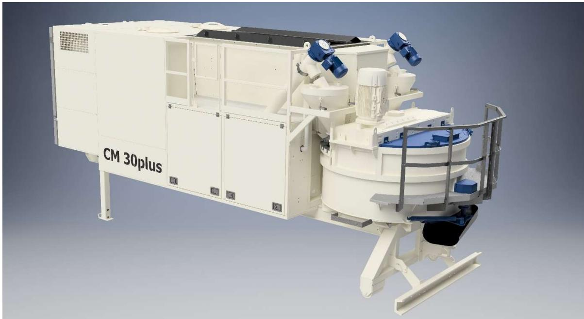
Die Mischanlage kann so wie oben zu sehen, **abgestellt arbeiten** oder auf dem **LKW** bzw. auf einem **Fahrgestell** stehend mischen.
